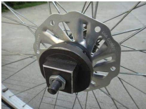
(3) 32mm スパナを用いて、ブレーキボスを反時計回りにまわし、脱着します。
