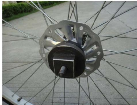
(2) リムーバーをロックナットで仮締めし、固定します。
